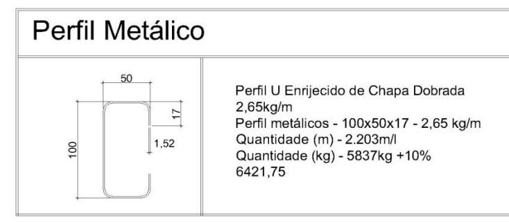
Figura 1 - Perfil U enrijecido a ser usado
